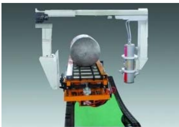
图 9-3 XYG-22508/3 型 X 射线检测系统结构示意图
