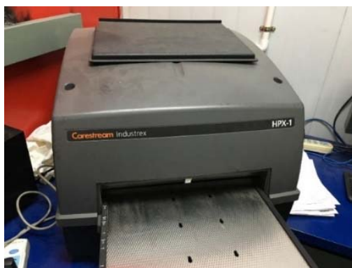
图 9-6 锐珂 HPX-1 Plus 数字 CR 系统外观示意图
