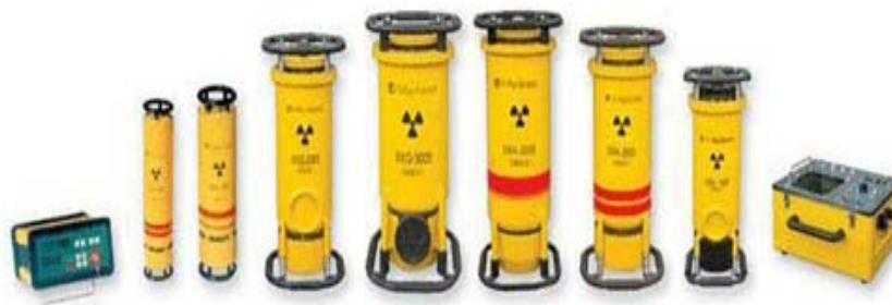
图 9-4 常见 X 射线探伤机外观图
