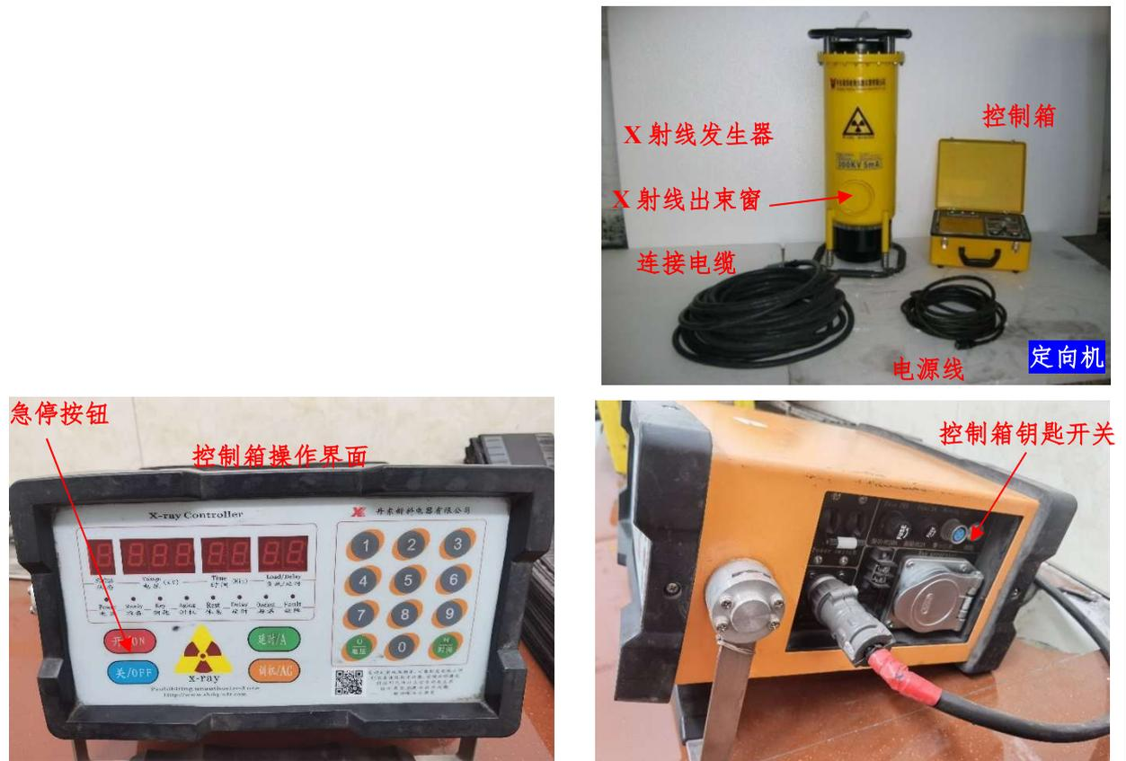
图 9-2 常见定向 X 射线探伤机及组件外观示意图
